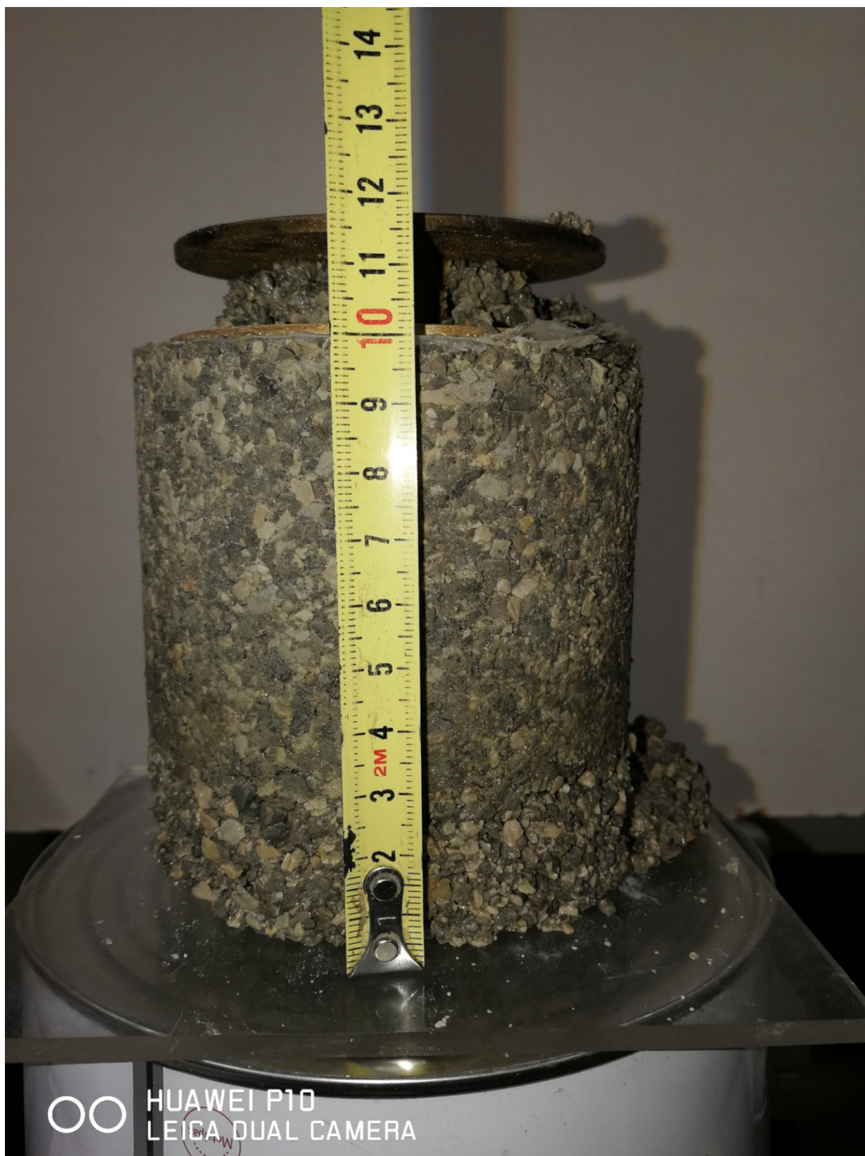
Näytteen alaosa, joka ei ole jäässä, hajosi näytettä sellistä otettaessa, joten alaosan huokoskivi ja osa näytteestä on nostettu ylähuokoskiven päälle.
